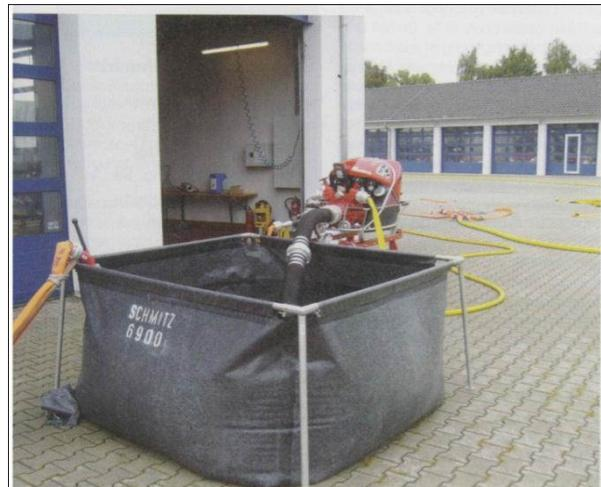
Abb. 1: In den Seminaren „Brandbekämpfung mit Schaum“ der LFKS Rheinland-Pfalz steht auch der Trinkwasserschutz auf dem Stundenplan. Im Bild ein einfach realisierter „freier Auslauf“, hier bei der Anwendung des Nebenschlussverfahrens (im Saugbetrieb). In der Füllleitung sitzt zusätzlich ein B-Absperrhahn oder ein Verteiler.
