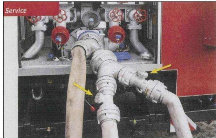
Einsatz zweier Rückflussverhinderer (Pfeil) parallel als Notlösung zum verbesserten Schutz des Trinkwassers. Zusätzlich erforderlich sind hier ein Verteiler und ein Sammelstück. Das ganze kann auch abgesetzt vom Fahrzeug aufgebaut werden. Foto: Feuerwehr Rappentstedt
