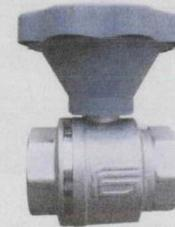
Kugelhahn mit Schließverzögerung als druckstoßarme Tankfüllarmatur. Bei dem Modell der Firma Aeromatic GmbH sorgt ein Getriebe für eine Übersetzung, die wiederum verhindert, dass der Kugelhahn nur mit einer 90-Grad-Drehung geöffnet oder geschlossen werden kann. Foto: Hersteller
