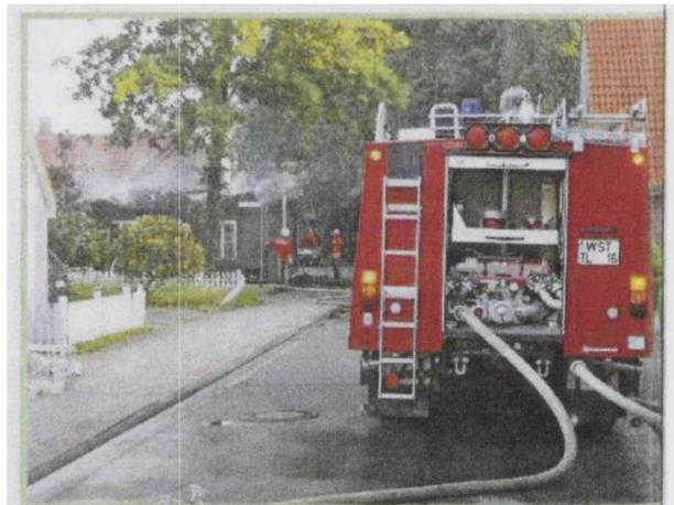
So sieht die Praxis aus: Direkter Zufluss vom Hydranten in den Tankfüllstützen des Löschfahrzeuges. Druckstöße können in diesem Fall nicht reguliert werden.
