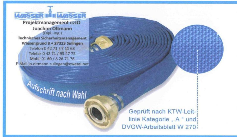
Trinkwasserschläuche für den zeitlich befristeten Einsatz müssen den hygienischen Anforderungen der KTW - Leitlinien und dem DVGW - Arbeitsblatt W 270 entsprechen. Zusätzlich sind die mechanischen Belastungen des Baustellenbetriebes zu erfüllen. Ab sofort sind Schläuche lieferbar, die diesen Anforderungen entsprechen und geprüft sind nach den KTW - Leitlinien Kategorie „ A “.
